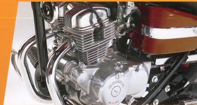
Antriebstechnik vom Feinsten: Zweizylinder-Viertakt-Reihenmotor
